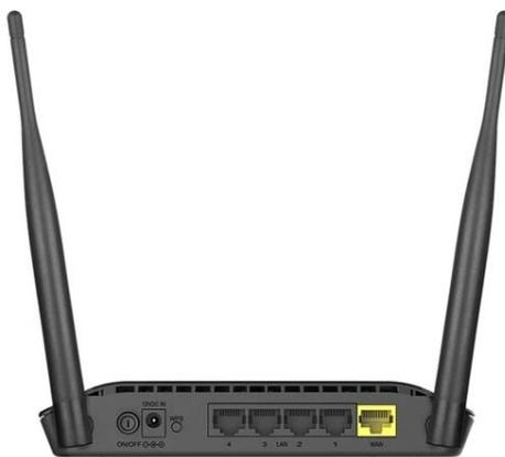
2. Подключите компьютер в любой LAN-порт вашего роутера, используя кабель (при этом необходимо отключить беспроводное соединение на вашем компьютере, если оно используется).
